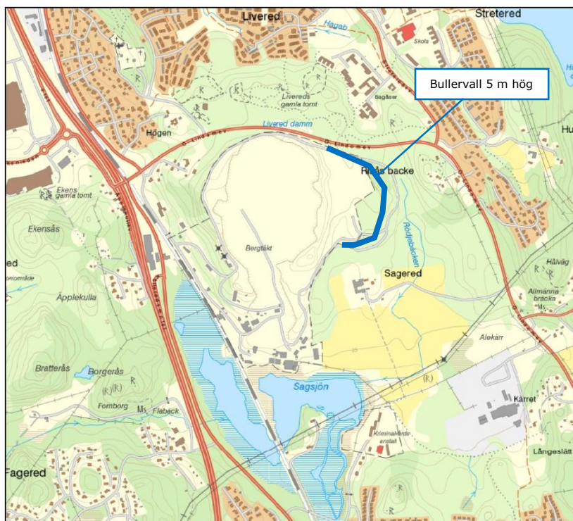
Figur 18. Antagen permanent bullervall från och med definierat startläge.
