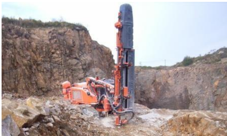
Figur 22. Bullerdämpad bergborr, Sandvik DX 780.
