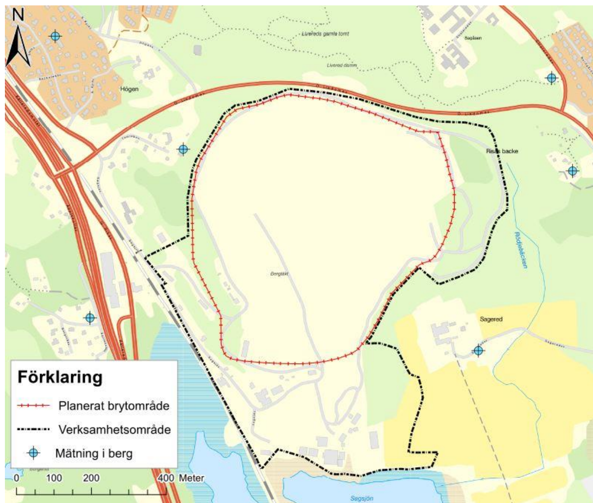
Figur 27 Mätning av grundvattennivåer i berg (energibrunnar)
