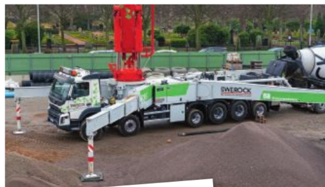
Vid 180 graders arbetsområde är det 8,5 meter mellan frambenen och lika långt mellan bakbenen. På sidan man arbetar är det 12,3 meter mellan fram- och bakben samt 14,8 meter mellan fram och bak på motsatta sidan.
